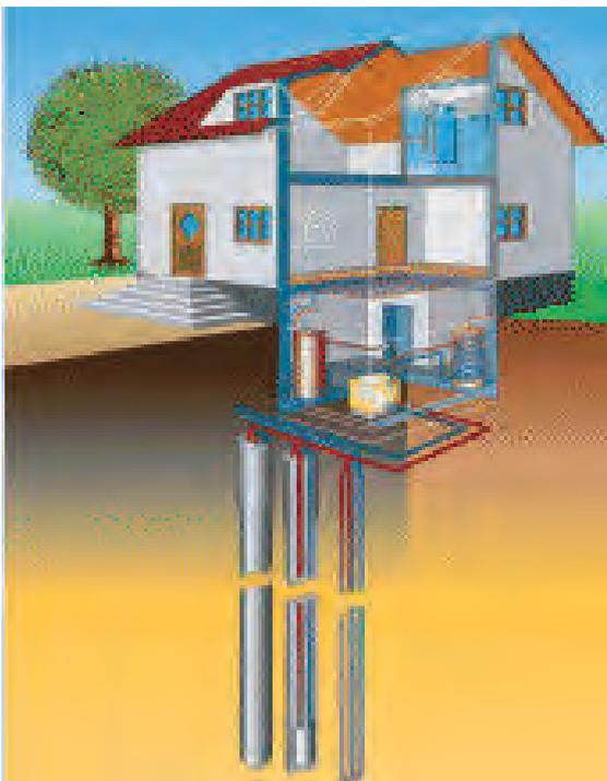
Systeme zur Nutzung der Tiefengeothermie (schematisch)
