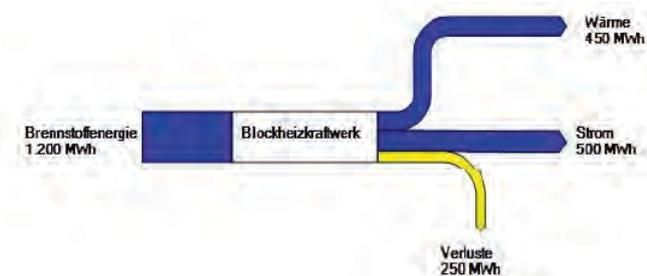
Abbildung 8: Energiebilanz der Kraft-Wärme-Kopplung
