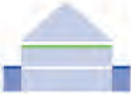
Oberste Geschossdecke 16 cm Dämmung mit WLG035
