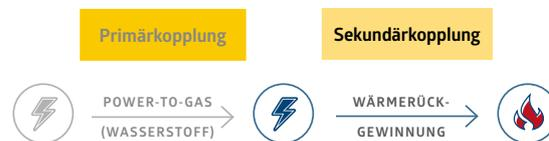
16 eFarm Projekt in Nordfriesland: Im Projekt eFarm nutzt die Fa. GP Joule die Abwärme von PEM-Elektrolyseuren und erreicht somit einen Gesamtwirkungsgrad von nahezu 100 %. Während 75 % der zugeführten Energie im Wasserstoff gespeichert sind, können die restlichen 25 % durch Nutzung der Abwärme verwertet werden [57].
