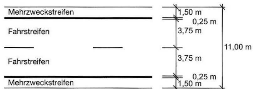
Abbildung 2: Bsp. für die Umgestaltung überbreiter zweistreifiger Straßen (FGSV, 2010)
